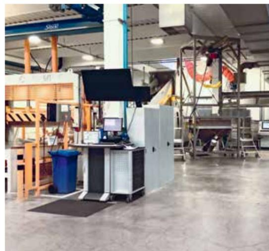
Regranulieranlage zum internen Recycling von Folienresten und Wiedereinsatz in hochwertigen PET- und Polyolefinfolien
